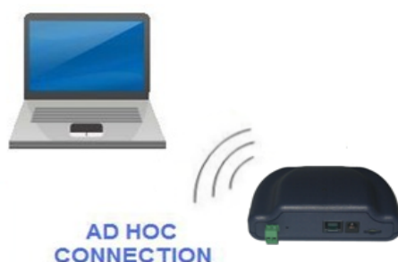
Immagine 8 – Prima connessione nodo IGROd Wi-Fi
